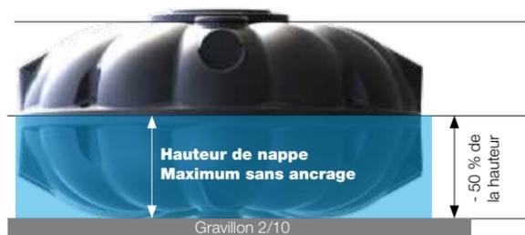
**Cas n°2 :** nappe située à plus de 50 % de la hauteur de la cuve, l'installation nécessite un ancrage
