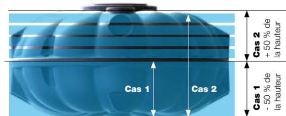
**Cas n°1 :** nappe située à moins de 50 % de la hauteur de la cuve, l'installation ne nécessite pas d'ancrage
