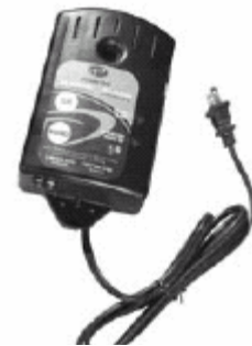
Boîtier d'alarme de haut niveau et de défaillance de la lampe
