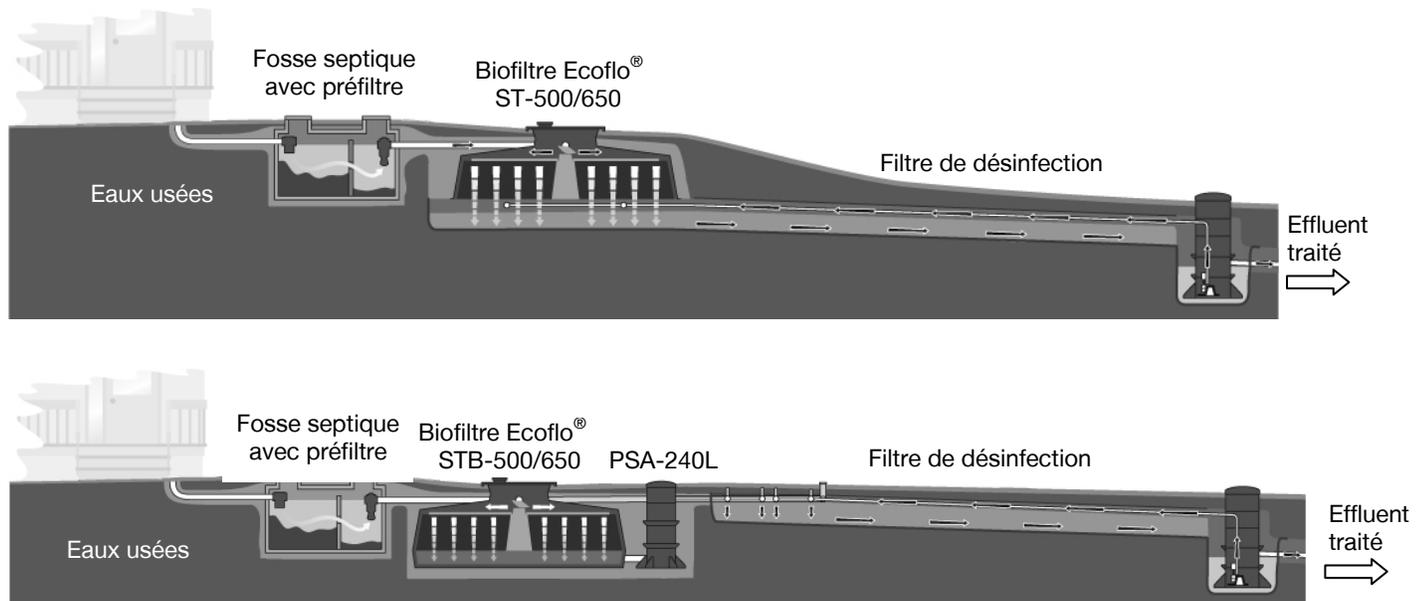
Votre installation d'épuration des eaux usées complète comprend une fosse septique munie d'un préfiltre (EFT-080 de PTA, PL-122 de Polylok ou EF-6 de Tuf-Tite) conformément à la certification NQ 3680-910 du Biofiltre Ecoflo®, 1 ou 2 Biofiltres Ecoflo®, un Filtre de désinfection (FDi) ainsi que toutes autres composantes nécessaires à votre type d'installation (poste de pompage ou séparateur de débit).
