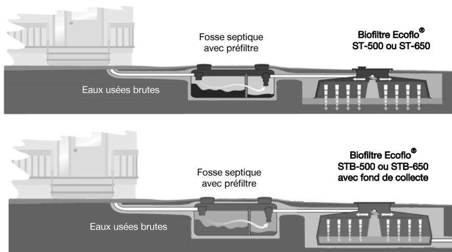
Votre installation d'épuration des eaux usées complète comprend une fosse septique munie d'un préfiltre (EFT-080 de PTA, PL-122 de Polylok ou EF-6 de Tuf-Tite) conformément à la certification NQ 3680-910 du Biofiltre Ecoflo®, un ou plusieurs Biofiltres Ecoflo® ainsi que toutes autres composantes nécessaires à votre type d'installation (poste de pompage ou séparateur de débit ou système de traitement tertiaire).
