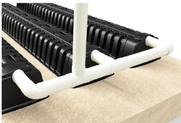
Raccorder la ventilation, non fournie, sur l'embout de sortie en fin des lignes du Biofiltre Linéaire ECOFLO. Utiliser les réductions excentrées M/F Ø 110x100 et les manchons F/F Ø110 au niveau du clip de sortie, comme précédemment avec les clips d'entrée.
