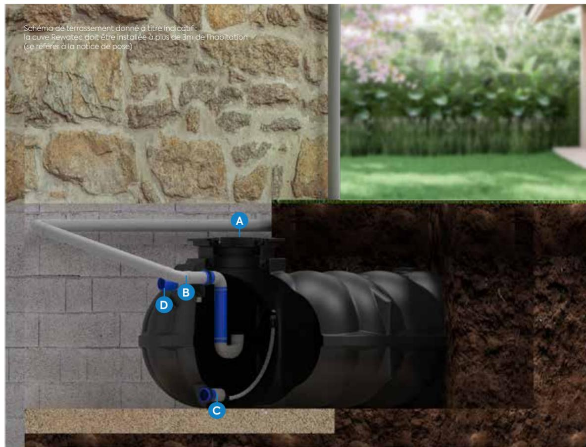
Schéma de terrassement donné à titre indicatif : la cuve Rewatec doit être installée à plus de 3m de l'habitation (se référer à la notice de pose)
