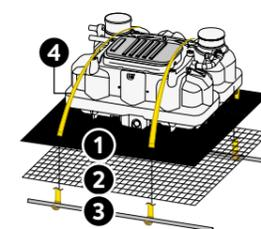
Kit sans ancrage béton composé de géotextiles ① et de sangles (x2) ④
