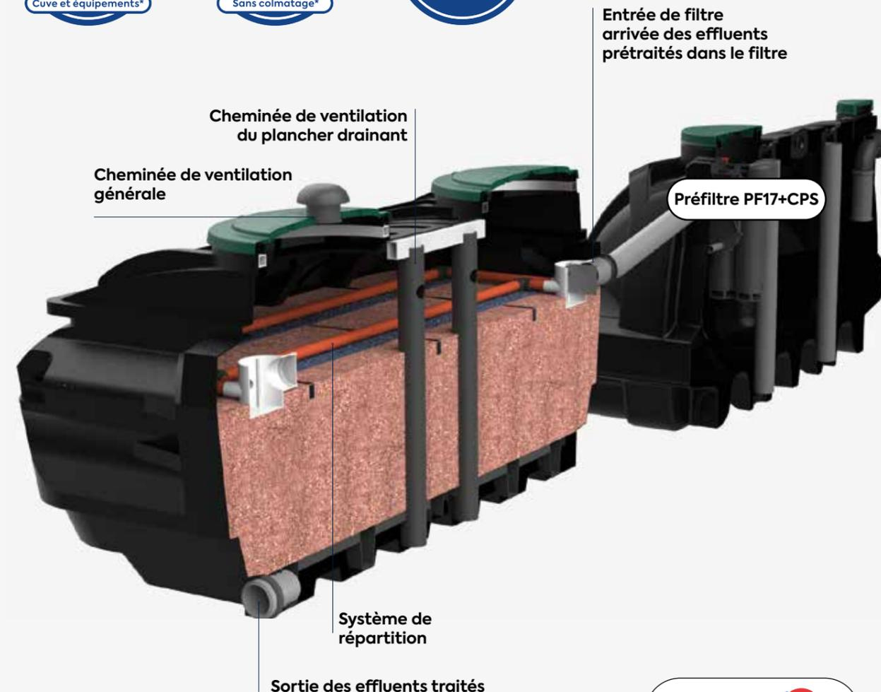
Entrée de filtre arrivée des effluents prétraités dans le filtre
