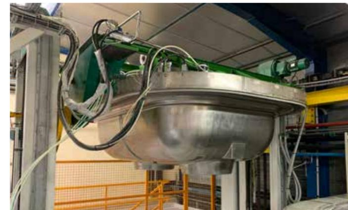
Les cuves sont fabriquées en composite polyester/fibres de verre selon un procédé exclusif : le RTM (Resin Transfer Moulding), procédé utilisé dans l'aéronautique et l'automobile.
