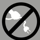
Vous ne devez en aucun cas utiliser le câble électrique de la pompe pour descendre ou remonter l'ensemble. En cas de non-respect de cette consigne et de détérioration de l'ensemble électrique de la pompe, aucun remplacement sous garantie ne pourra être effectué.
