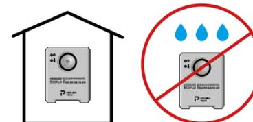
**LE BOITIER DOIT ÊTRE IMPÉRATIVEMENT INSTALLÉ À L'INTÉRIEUR DE L'HABITATION.**
