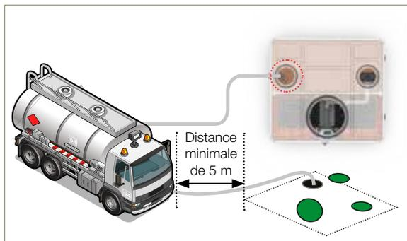
Les opérations de vidange (via l'ouverture située à l'entrée de la fosse toutes eaux (la plus proche de l'entrée des eaux usées)) incluent l'enlèvement des flottants (p. ex. "chapeau" de graisse) et la vidange des boues accumulées dans la fosse (à vidanger entièrement).
