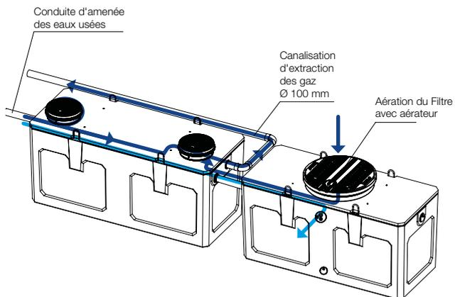
Détail de la canalisation d'extraction des gaz (fosse) et de l'aération du filtre EPARCO Compact Béton, présentation en monolithe
