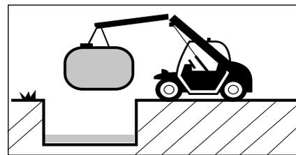
Mise en fouille et dépose sur lit de pose avec le moyen de manutention approprié
