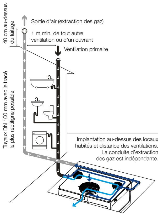
Exemple de schéma de ventilation de la fosse d'un modèle EPARCO Compact Béton monolithe raccordé à une habitation
