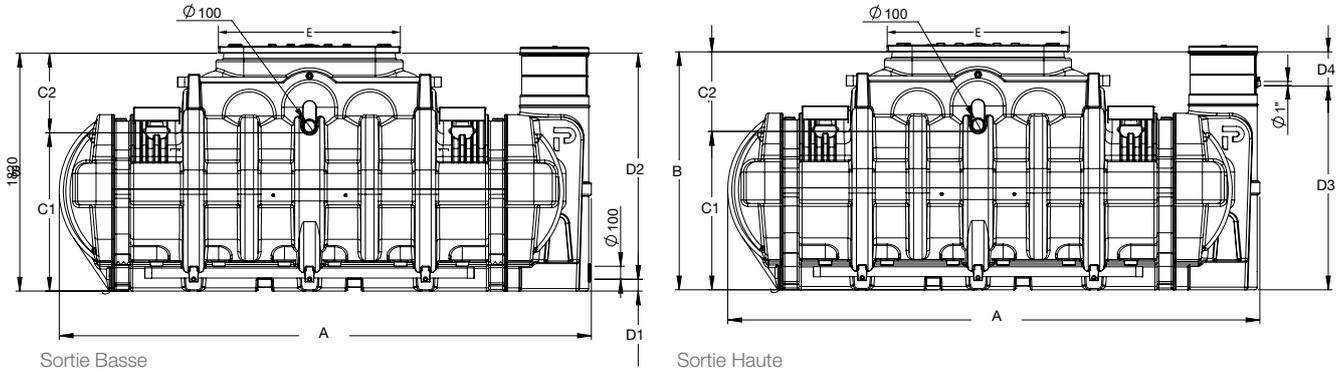
Dimensions en mètre. Les poids des filtres sont des poids moyens. Le taux d'humidité du milieu filtrant peut faire varier le poids indiqué.
