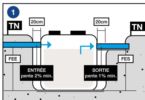
Cas d'un modèle pack sortie haute de la gamme EPARCO Compact PE
