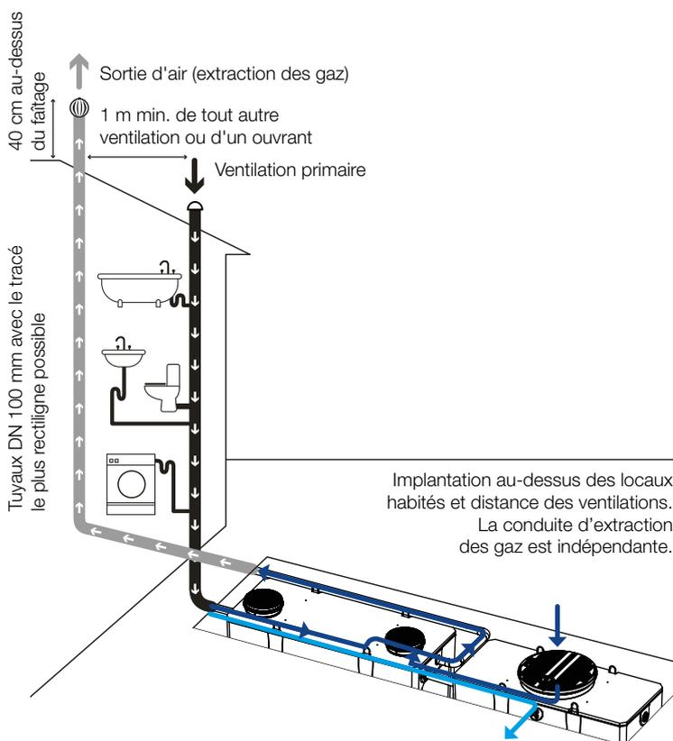
Exemple de schéma de ventilation de la fosse d'un modèle EPARCO Compact Béton ligne raccordé à une habitation
