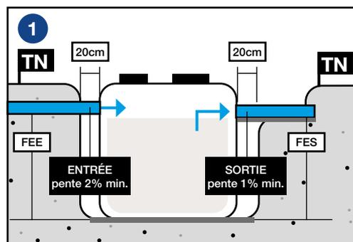
Cas d'un modèle monolithe sortie haute de la gamme EPARCO Compact Béton
