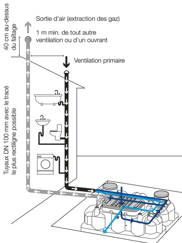
Implantation au-dessus des locaux habités et distance des ventilations. La conduite d'extraction des gaz est indépendante.
