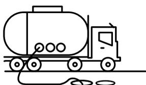
Le dispositif doit être périodiquement vidangé selon les modalités définies dans l'arrêté "vidangeurs" du 7 septembre 2009 modifié, lorsque la hauteur des boues atteint 50 % du volume utile de la fosse toutes eaux (capacité maximale de stockage des boues du dispositif autorisée). **La hauteur maximale de boues autorisée depuis le fond de la cuve est détaillée dans le tableau ci-dessous pour l'ensemble des modèles de la gamme EPARCO Compact décrits dans le présent guide.**
