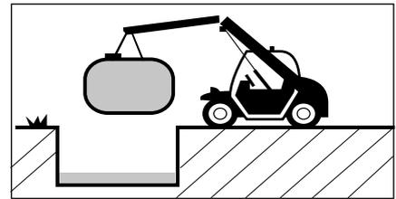
Mise en fouille et dépose sur lit de pose avec le moyen de manutention approprié
