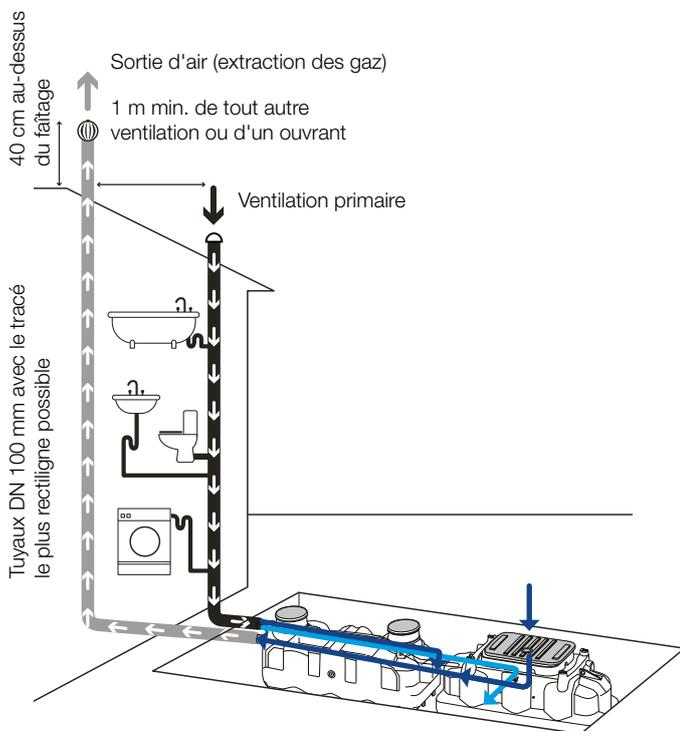
Implantation au-dessus des locaux habités et distance des ventilations. La conduite d'extraction des gaz est indépendante.
