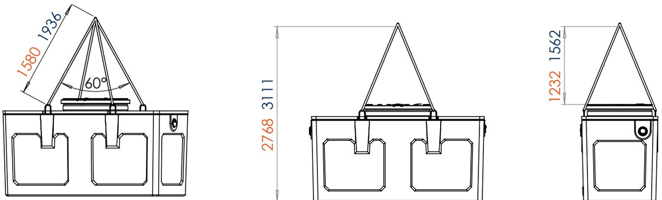
Levage Filtre EPARCO Compact Béton ligne 5 EH
