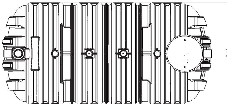
Fosse toutes eaux en PEHD (Polyéthylène à Haute Densité) en amont d'une filtration traditionnelle (fosse munie du préfiltre PF17 et du connecteur sécurisé CPS)
