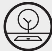
Ne jamais planter un arbre à moins de 5 m du couvercle du filtre compact Ecoflo et à moins de 3 m de la zone d'infiltration,
