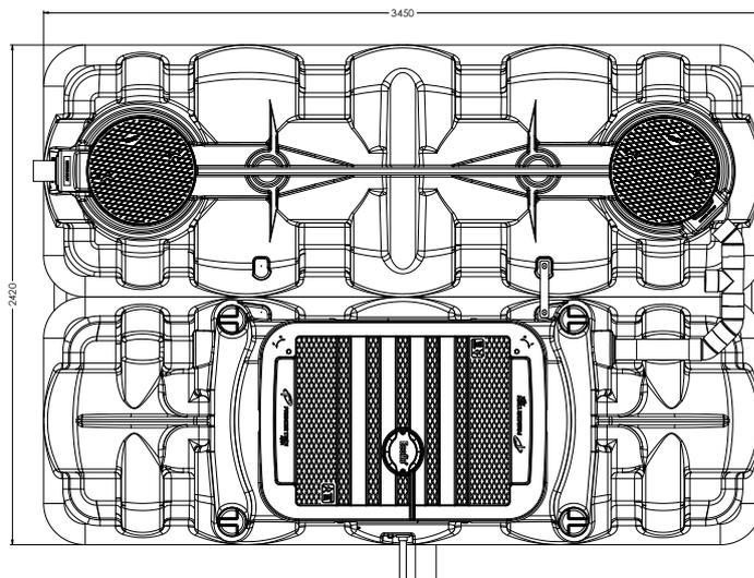
Filtre compact composé de 2 cuves en PEHD (Polyéthylène à Haute Densité) : 1 fosse toutes eaux (munie du préfiltre PF17 et du connecteur sécurisé CPS) et 1 filtre naturel végétal composé de fragments de coco pour filtration des eaux usées domestiques
