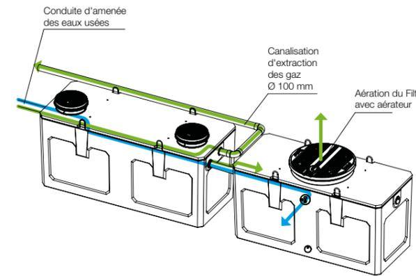
Détail de la canalisation d'extraction des gaz (fosse) et de l'aération du filtre ECOFLO Béton 3.0, présentation en monolithe
