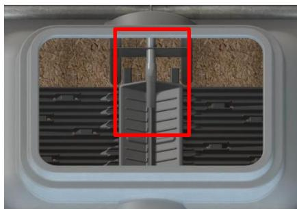
É também necessário verificar se o tubo de abastecimento está corretamente alinhado com a estrutura basculante. Caso tal não se verifique, pode desapertar os parafusos da placa e movê-los ligeiramente até estarem alinhados.
