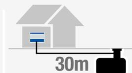
Solido est livré avec un câble de connexion 30m (1 seul câble de connexion avec la Micro Station est nécessaire)
