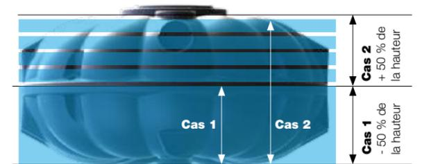
**Cas n°1 :** Nappe située à moins de 50% de la hauteur de la cuve, l'installation ne nécessite pas d'ancrage
