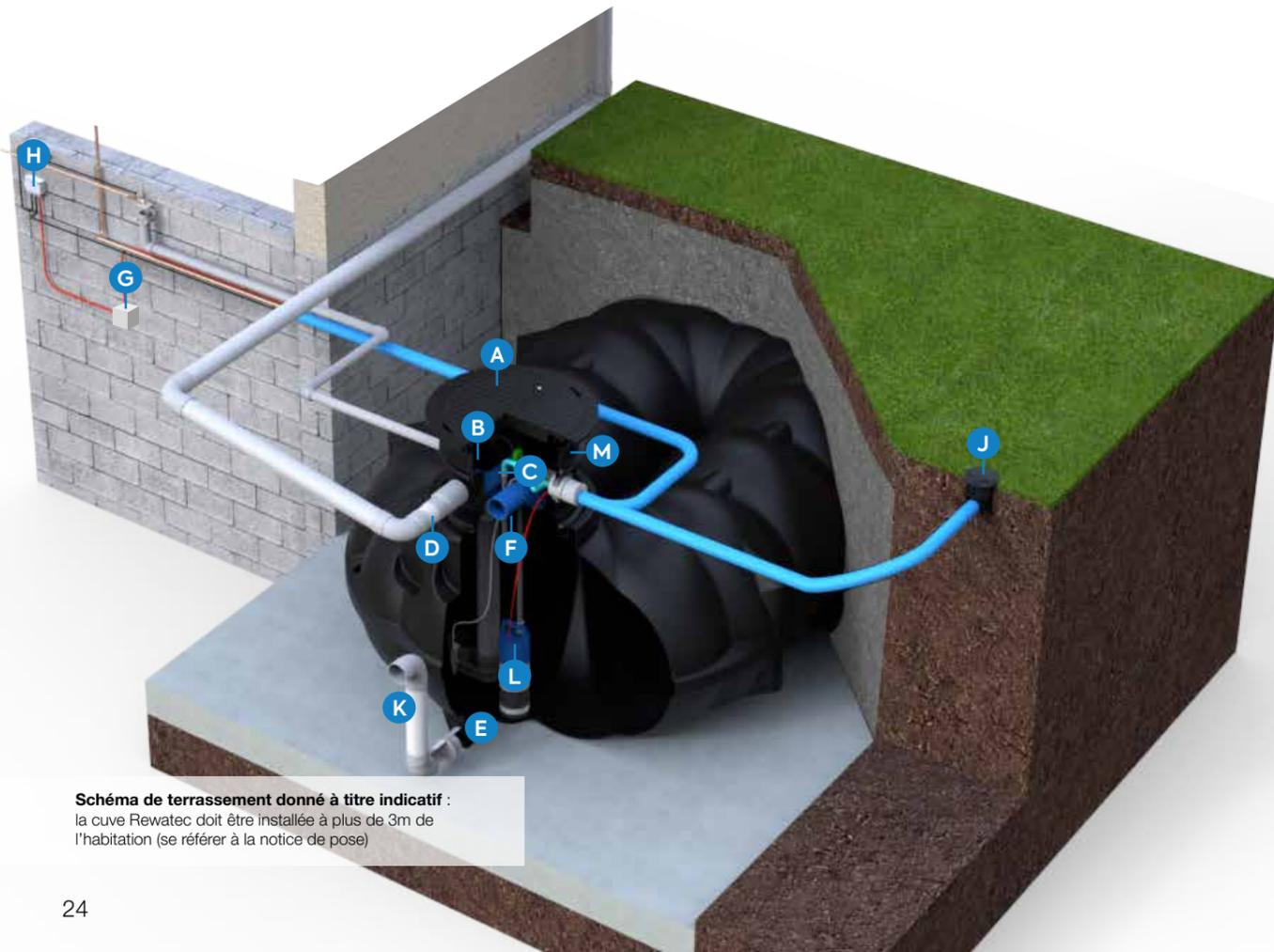
Schéma de terrassement donné à titre indicatif : la cuve Rewatec doit être installée à plus de 3m de l'habitation (se référer à la notice de pose)
