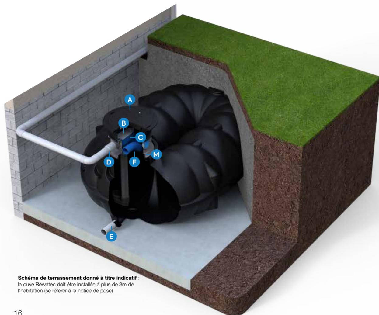
Schéma de terrassement donné à titre indicatif : la cuve Rewatec doit être installée à plus de 3m de l'habitation (se référer à la notice de pose)
