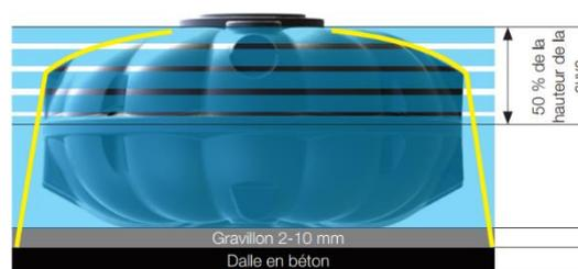
\* Le dimensionnement de la dalle doit être validé par un technicien compétent.
