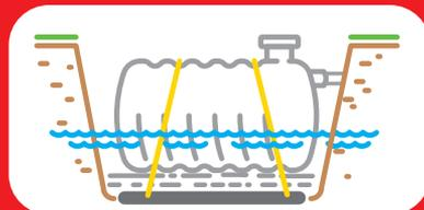
La hauteur maximale de la nappe phréatique **NE DOIT PAS** être supérieure à 1/3 de la hauteur de la cuve. Il est nécessaire de ancrer le réservoir à la dalle avec des sangles.
