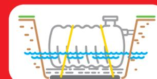
La altura máxima del nivel freático **NO DEBE** ser más alta que 1/3 de la altura del depósito. Es necesario anclar el depósito con cintas a la losa. Si el nivel freático es más alto de 1/3, ponerse en contacto con nosotros.
