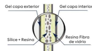
Sección transversal del material
