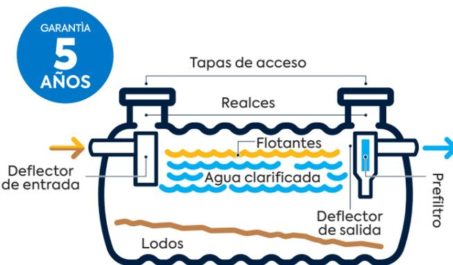
En la zona superior, los aceites y grasas suben y forman una capa flotante. En la zona inferior, los sólidos se depositan en el fondo del depósito y forman los lodos. Tanto los materiales flotantes como los lodos hay que retirarlos periódicamente por empresas especializadas.
