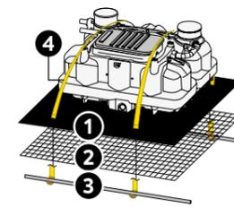
Kit sans ancrage béton composé de géotextiles ① et de sangles (x2) ④
